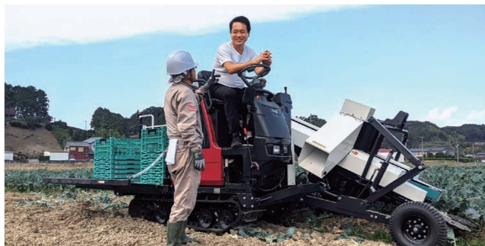
自動操舵システムにより、ハンドルを持たなくても真っ直ぐな作業を可能にする。
