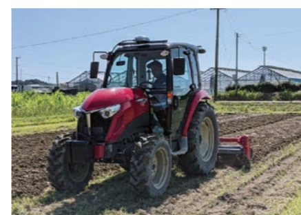
自動操舵システムにより、ハンドルを持たなくても真っ直ぐな作業を可能にする。
