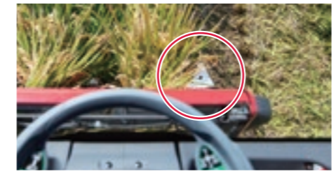
作業中にデバイダを目視できるので、条合わせがしやすい
