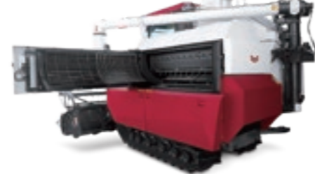
※1:掃除や手入れが必要な各部に掃除口があり簡単に点検・掃除ができる(ヤンマー普通型コンバインYHシリーズ共通)
